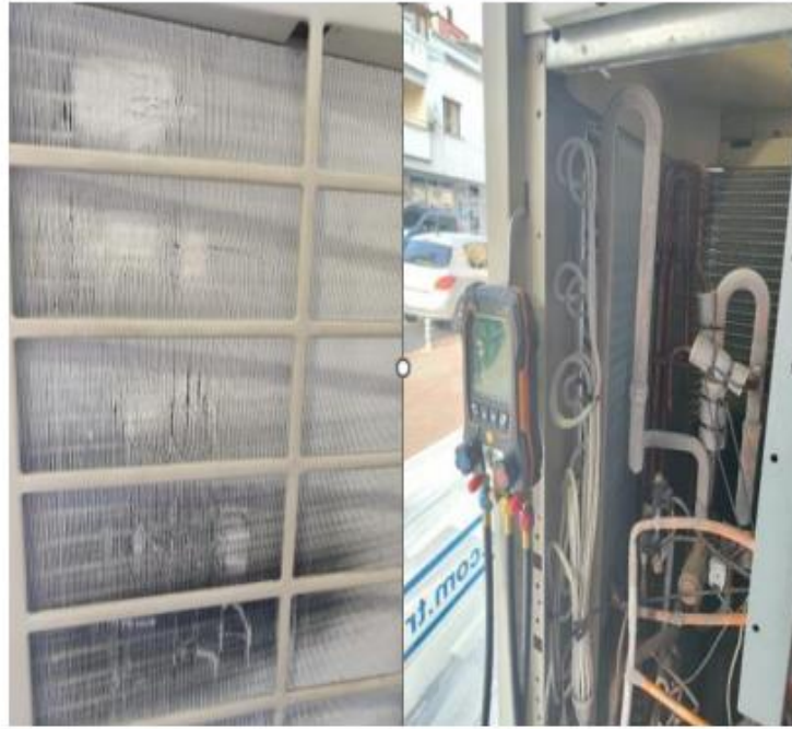
Şekil 11. Deney Düzeneğindeki Evaporatör Yüzeyinde Buzlanma Oluşumu
